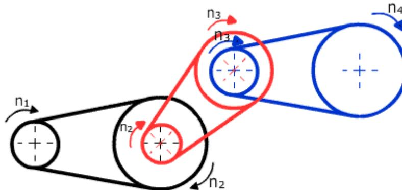
Con las transmisiones de poleas se pueden conseguir **cajas de velocidades** entre dos árboles paralelos que monten varios pares de poleas escalonadas. Es necesario mantener constantes la velocidad de giro del árbol motor y la longitud de la correa.
